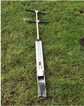
Echantillonneur à tourbe (Peat Sampler) : système télescopique à gouge en demi-lune de 50 cm de long, munie d'un clapet tournant permettant de récupérer à une profondeur déterminée des carottes d'échantillons dont la siccité est faible. Convient bien pour les sédiments les plus fins et en épaisseurs importantes pouvant atteindre plusieurs mètres.
